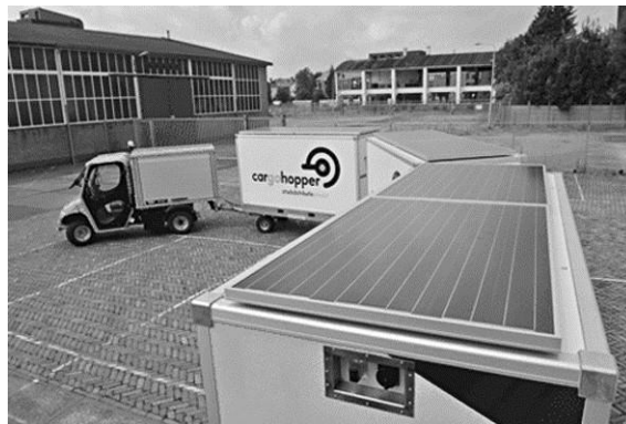
zonnepanelen op dak van laadbakken
